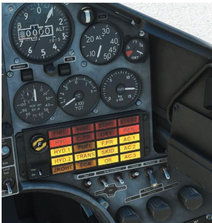
En passant au tableau de bord de droite, vérifiez que l'indicateur "OXY CWP" est éteint., la jauge d'oxygène affiche plus de la moitié de sa capacité. et que l'indicateur de flux d'oxygène montre un débit correct.
