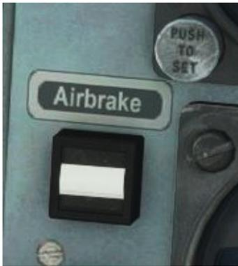
Poussez l'interrupteur du frein à air vers l'avant en position **IN** avant de le relâcher. Vérifiez que l'indicateur de frein à air sur le tableau de bord gauche est noir, ce qui indique que le frein à air est rétracté.
