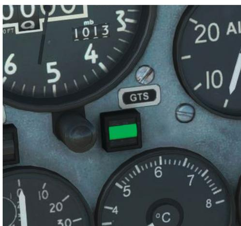
Mettez l'interrupteur de démarrage moteur sur "**START**" et relâchez-le. Surveillez l'indicateur de rotation, dès qu'il devient vert et que le régime moteur atteint 15-20%, cliquez sur le levier d'arrêt de ralenti pour avancer la manette des gaz sur la position **IDLE**.
