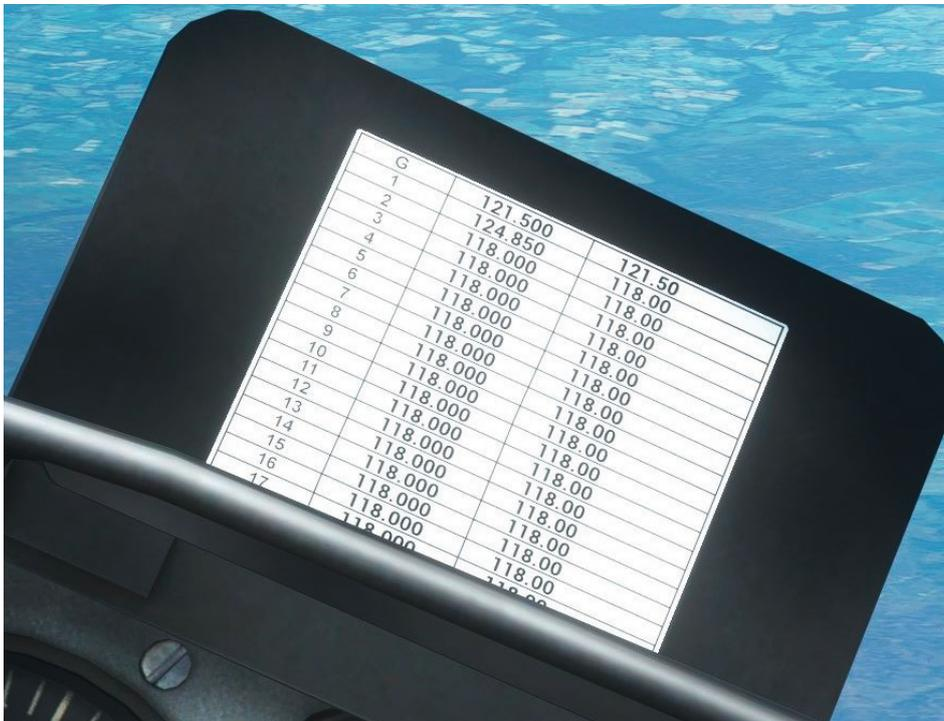
Si vous revenez au mode manuel en tournant le sélecteur de fréquence sur la position **MAN**, vous verrez que la fréquence préréglée a maintenant été réglée en mode veille COM 1, affichée dans la partie inférieure de l'écran. Pour activer la fréquence, appuyez sur le bouton **ENTER**.
