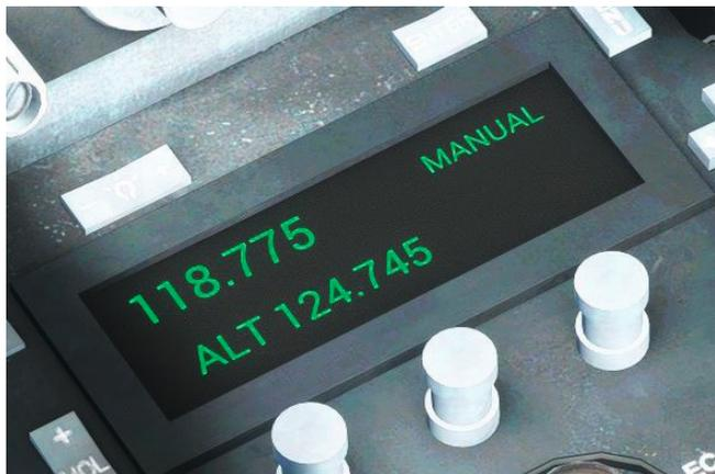
Appuyez maintenant sur le bouton **MENU** pour activer le mode de stockage. À l'aide du commutateur à bascule de navigation, sélectionnez le canal 2 (CH : 2), puis appuyez sur le bouton **ENTER** pour enregistrer la fréquence active COM 1 dans le canal préréglé 2.
