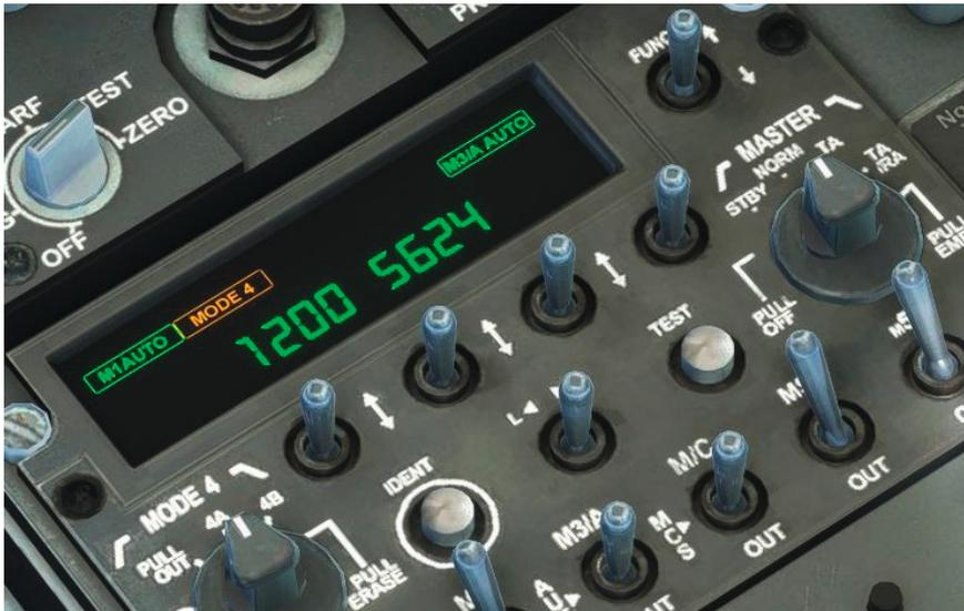
MSFS a une capacité de transpondeur limitée et seuls les modes civils sont pris en charge, donc seul le code Mode 3/A (à droite) est utile, bien que vous puissiez modifier les deux pour simuler des opérations dans le monde réel. Nous allons maintenant modifier le code Mode 3/A.
