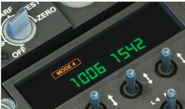
Déplacez le commutateur FUNC vers le bas deux fois de plus pour sélectionner la page d'affichage de l'ID de vol du Mode S. Ici, vous pouvez définir un ID de vol alphanumérique à utiliser avec le Mode S, en utilisant la même méthode que pour modifier les codes du transpondeur.
